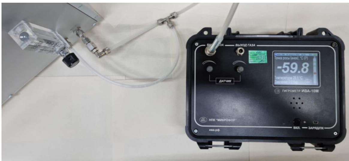
Рисунок 39 – Подключение гигрометра ИВА-10М.
