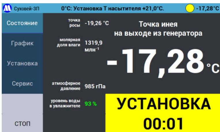
Рисунок 31 – Процесс установки температуры точки инея.
