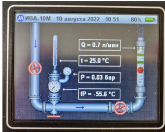
Рисунок 42 – Пневматическая схема на экране гигрометра ИВА-10М.
